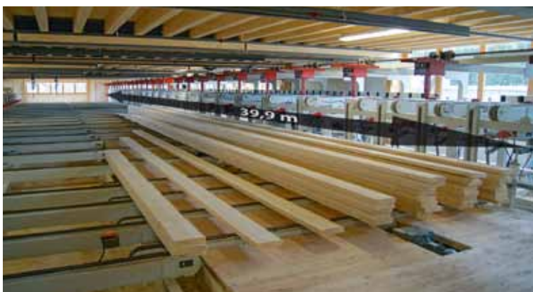
Bis zu 40 m lange keilgezinkte Lamellen können im Querlager aushärten, bevor es in Richtung Hobelmaschine und Beleimung weitergeht
