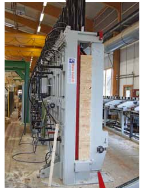
Die 38 Zylinder der 23,9 m langen Rutz-BSH-Pressen können einzeln angesteuert werden
